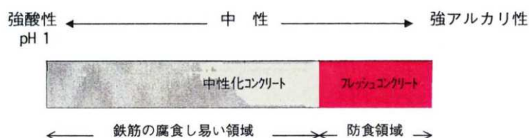
<pHと鉄筋の腐食との関係>
